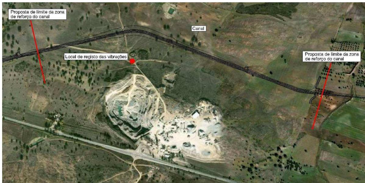
Figura 11 – Canal Pisão-Roxo, na zona da Pedreira. Traçado, localização do ponto de registo de vibrações e limites da zona de reforço do canal.
