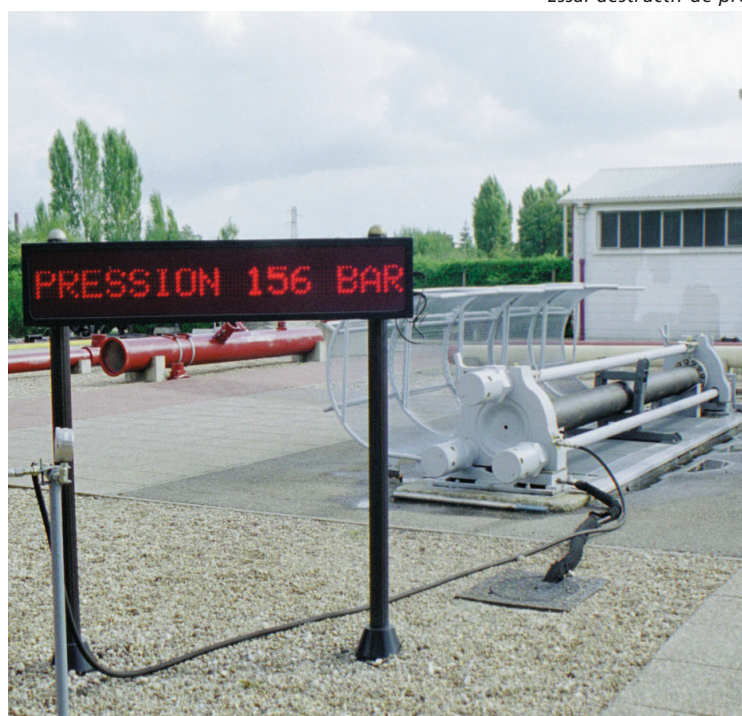
Essai destructif de pression sur tuyau DN 250
