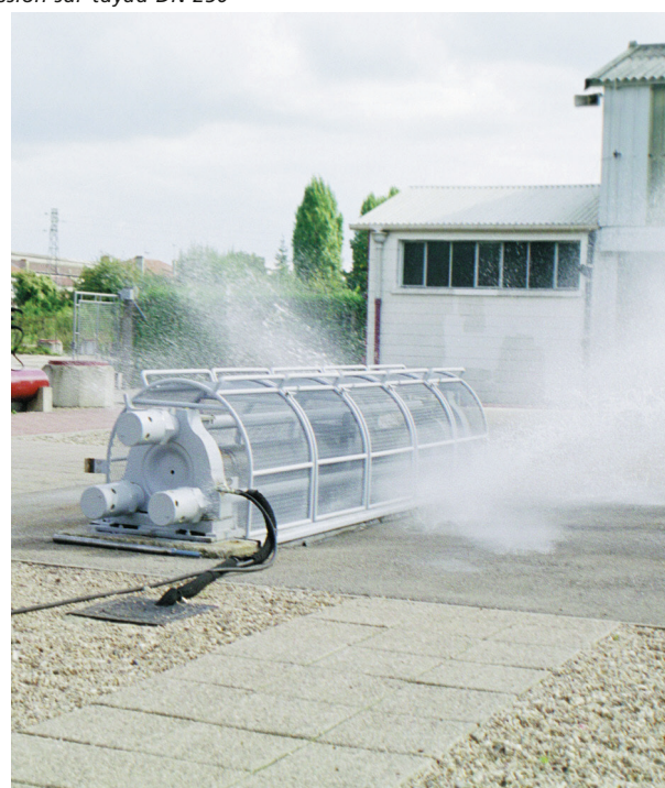
Essai destructif de pression sur tuyau DN 250
